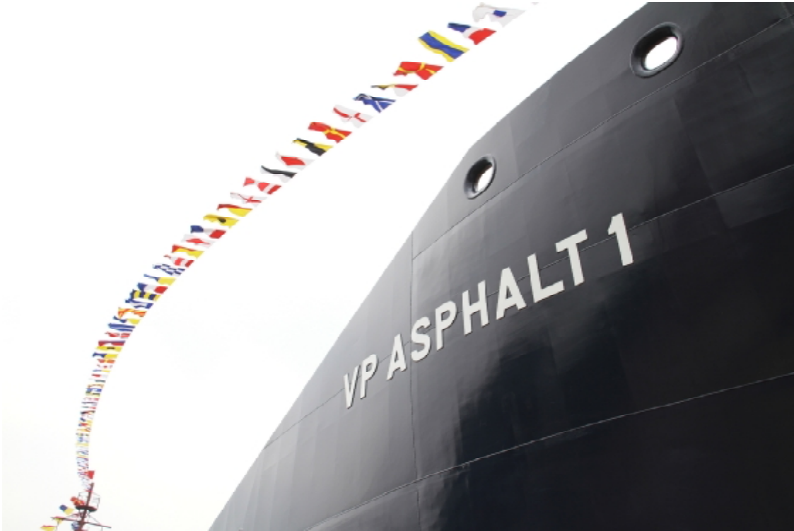
Tàu chở nhựa đường VP Asphalt 01 trọng tải 2.800 DWT
